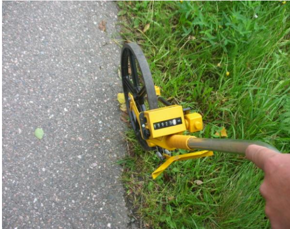
Kuva 6.16 Mittapyörä ja käyttö maastossa (Sykli 2010)
