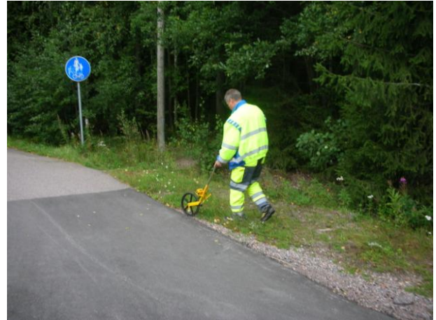
Kuva 6.16 Mittapyörä ja käyttö maastossa (Sykli 2010)
