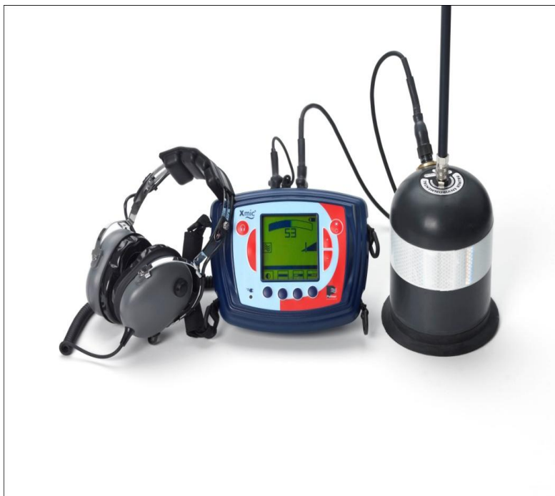
Kuva 6.4 Digitaalinen maamikrofonilaitteisto (Suomen Putkisto Tarvike 2010)
