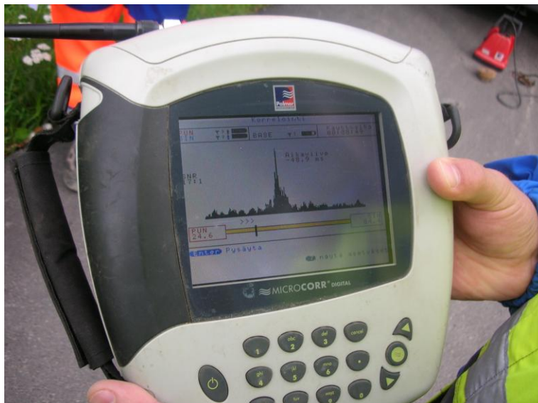
Kuva 5.9 Korrelaattorin grafiikka osoittaa vuodon sijaintia (Sykli 2010)
