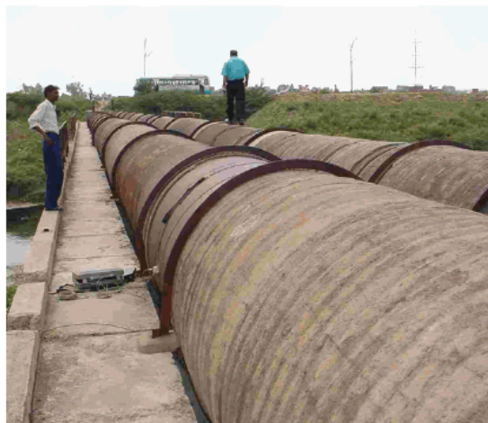
Kuva 3.2 Verkostoon pumpattavan vesimäärän mittaus pysyvillä ja tilapäisillä mittareilla (Pilcher 2004)
