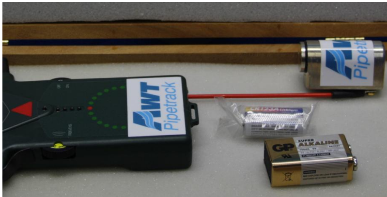
Kuva 6.15 Awt-paikannuslaitteisto; vastaanotin, virtalähteet ja elementin suojakapseliin asennettava lähetin (Allwatec 2010)
