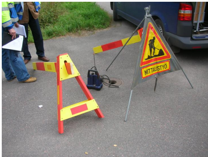
Kuva 5.7 Akustisten loggeri kytkettynä sulkuventtiiliin jatkokaraan (Sykli 2010)
