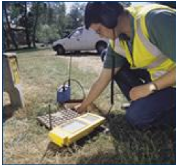
Kuva 6.6 Digitaalinen korrelaattori käytössä (Primayer 2004)
