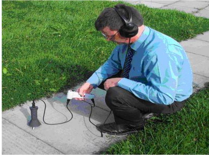
Kuva 6.3 Maamikrofoni käyttöä, kun putket on asennettu matalalle (Gutermann International 2006)
