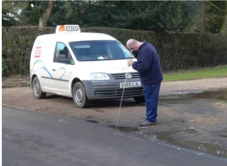
Kuva 6.1 Vuodonkuuntelu perinteisellä kuuntelutikulla (Mid Kent Water 2007)
