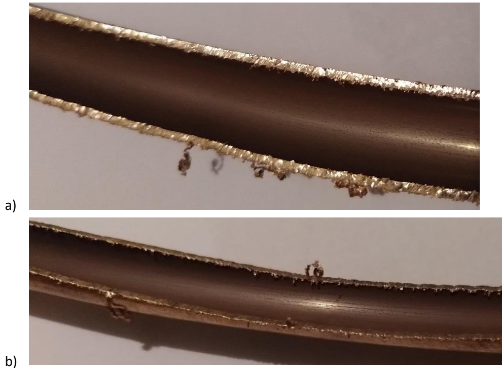
Kuva 4. Käyttämättömän kieppi kupariputken sisäpinta (10 mm R220, tyyppihyväksytty käyttövesiasennuksiin Suomessa) eri kuvakulmista a) ja b).
