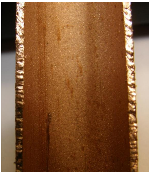
Kuva 5. Käyttämättömän kupariputken sisäpinta (tyyppihyväksytty käyttövesiasennuksiin Suomessa) noin 1 vuoden säilytyksen jälkeen.
