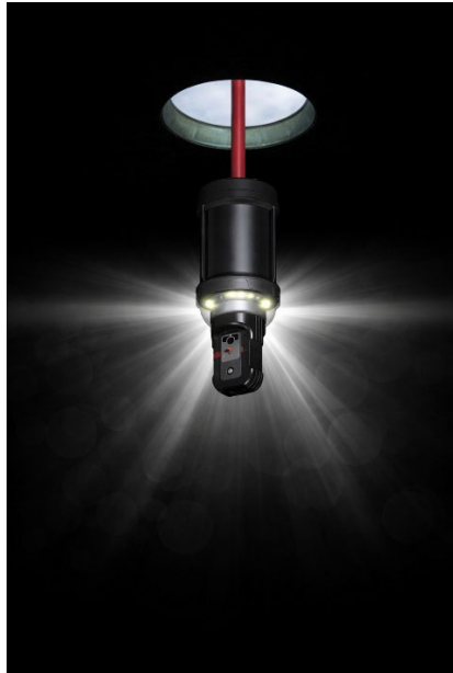
Kuva 21. 360-kamera kaivon kuvauksessa.
